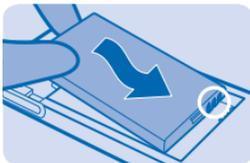
5. Drücken Sie auf die rückseitige Abdeckung, bis sie einrastet. Drücken Sie zum Einschalten des Mobiltelefons lange die Ein-/Aus-Taste
