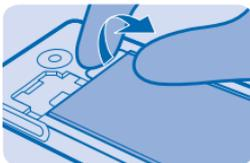
3. Schieben Sie die SIM-Karte mit der Kontaktfläche nach unten hinein.
