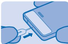
2. Setzen Sie die Speicherkarte mit der Kontaktfläche nach unten ein.
